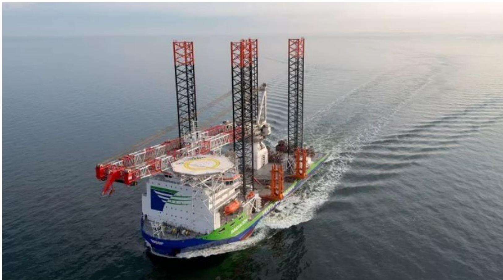
Оффшорное судно, Innovation SRP630 x 4, 3500 кВт + STT3030 x 3, 2800 кВт
