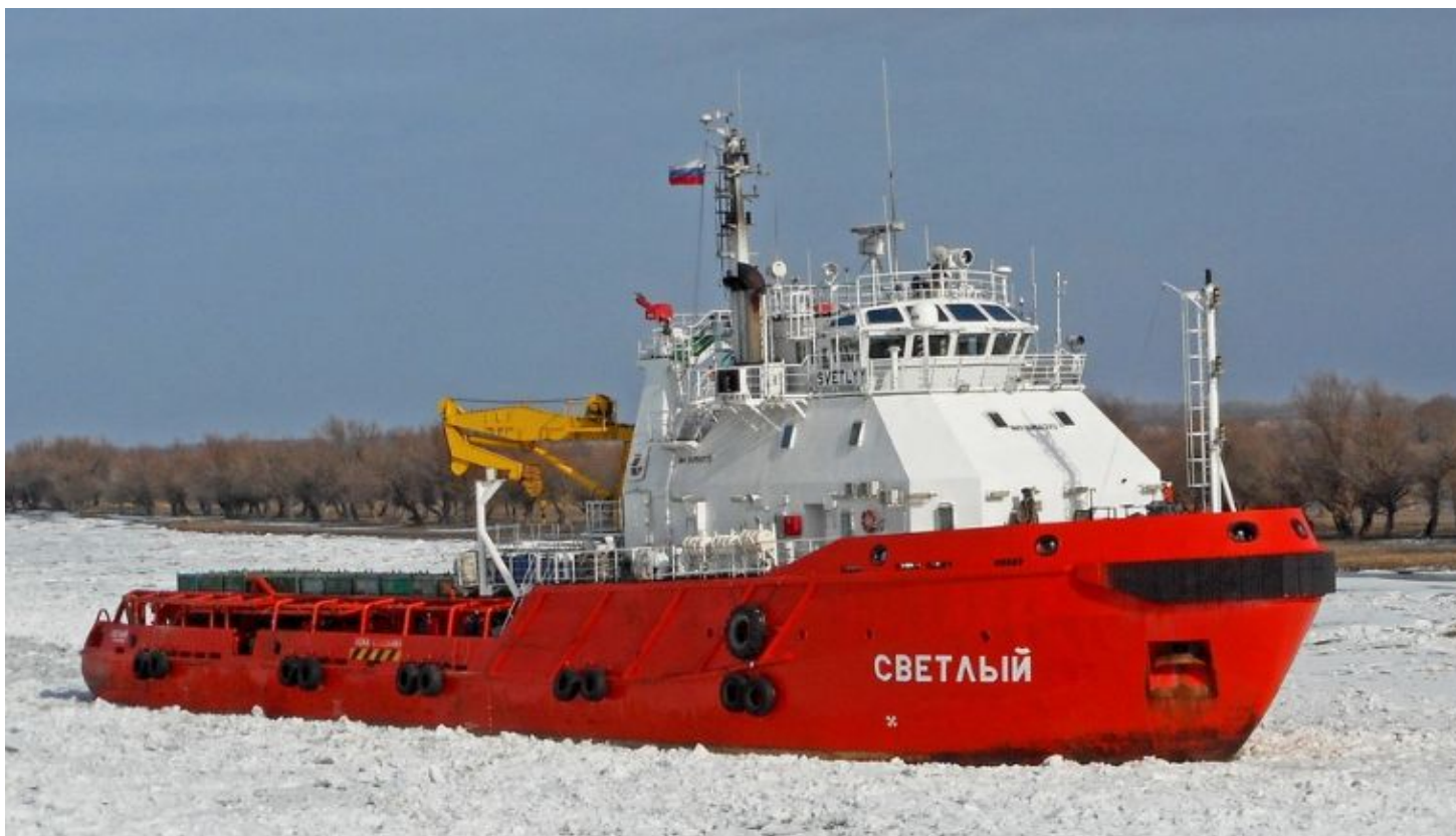
Судно обеспечения, Светлый, IMO 9356373 SCP 1004 ZG x 2, 2640 кВт каждая
