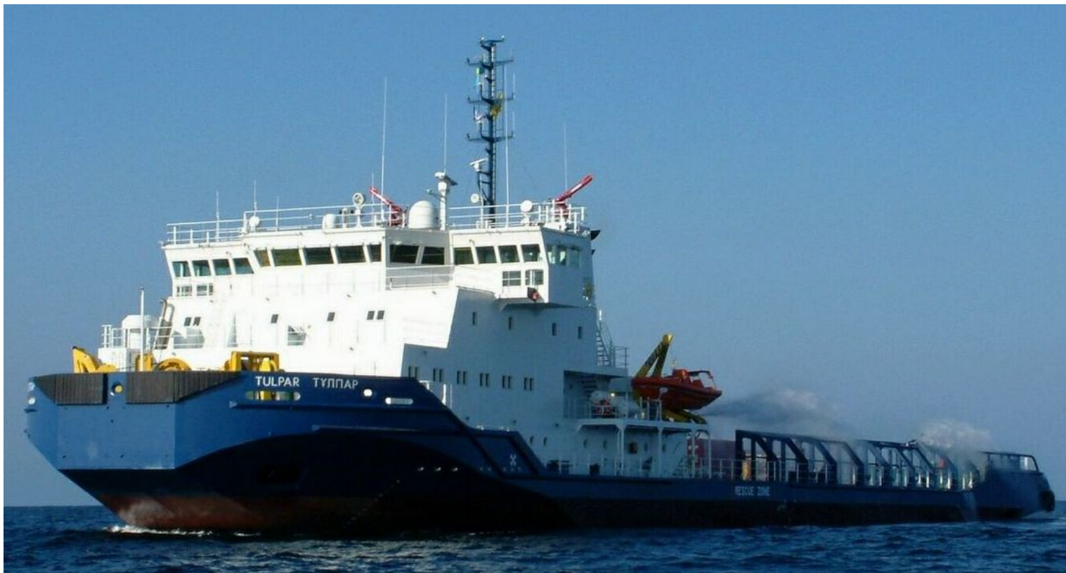
Судно обеспечения, Тулпар, IMO 9263083 2 SRP2020, 2000 кВт + SPJ 220 x 2 (850 кВт) Ледовый класс 1A Super
