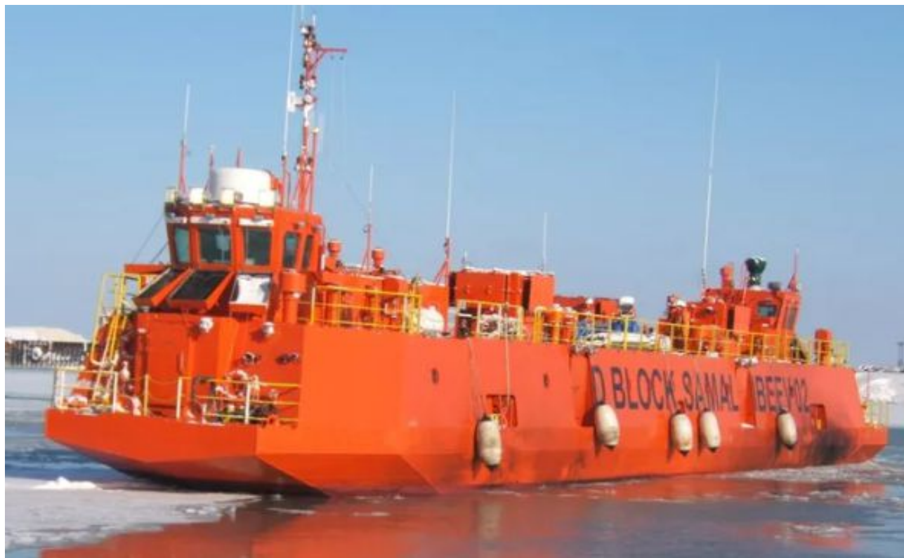
Аварийно-спасательное судно, IBEEV 02, IMO 9384344 2 SRP550FP, 550 кВт Ледовый класс 1А
