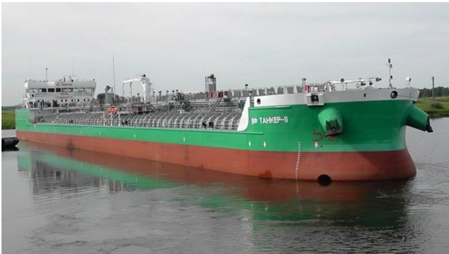
Судно проекта RST27 (45 судов серии), ВФ Танкер 11, IMO 9645009 SRP 1012 FP x 2, 1200 кВт каждая + STT170, 230 кВт
