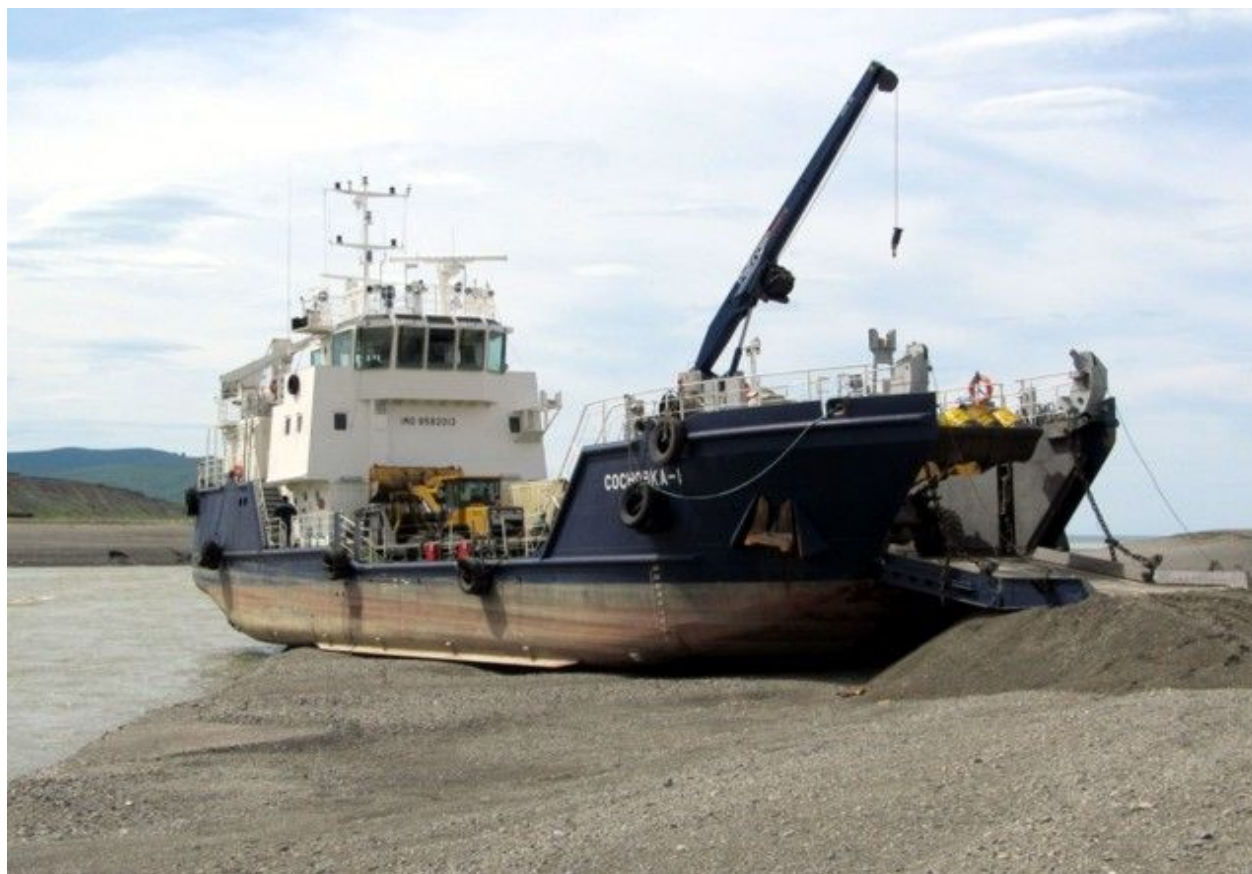
Судно проекта DCV47, Сосновка-1, IMO 9582013 SRP 200 FP x 2, 300 кВт каждая
